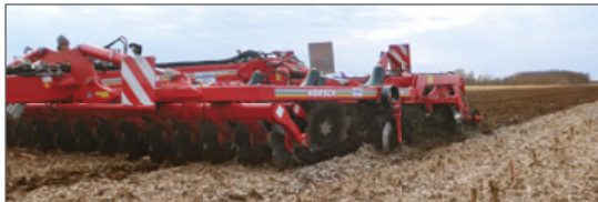
Eine Arbeitsbreite von bis zu 4,80 m und eine Arbeitstiefe von 35 cm sind möglich.
