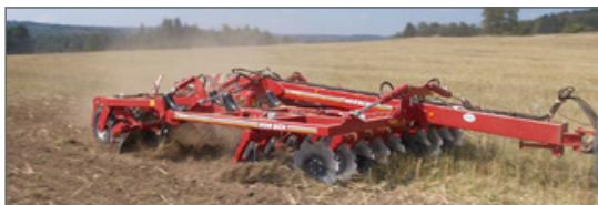
In einem Arbeitsgang: mischen - lockern - rückverfestigen
